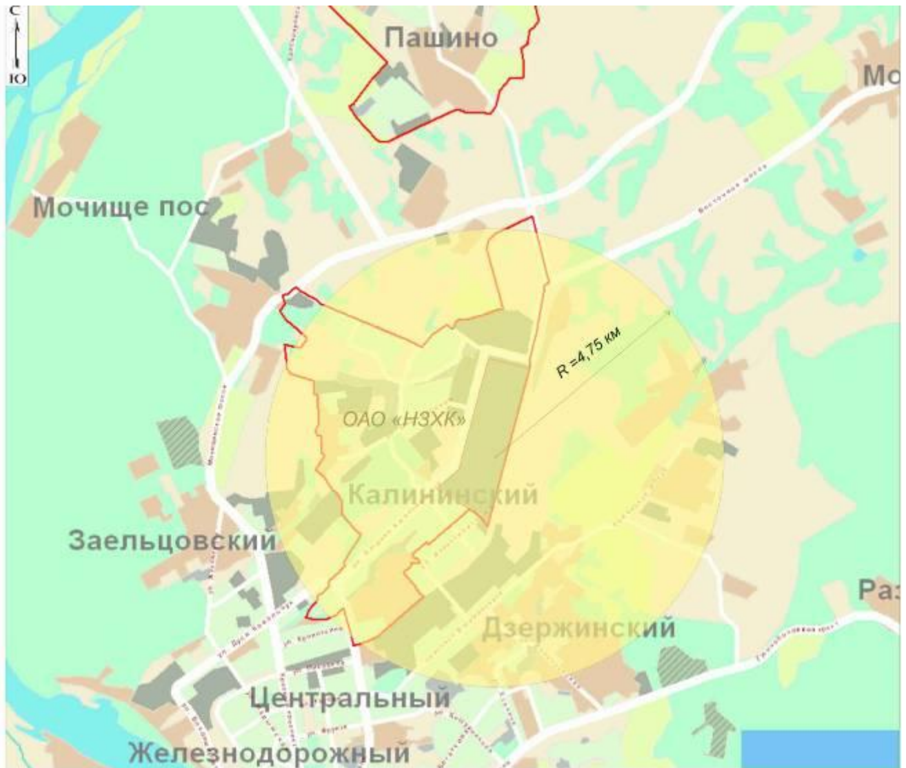
Зона возможного заражения при разгерметизации железнодорожной цистерны с азотной кислотой на ОАО «НЗХК»
