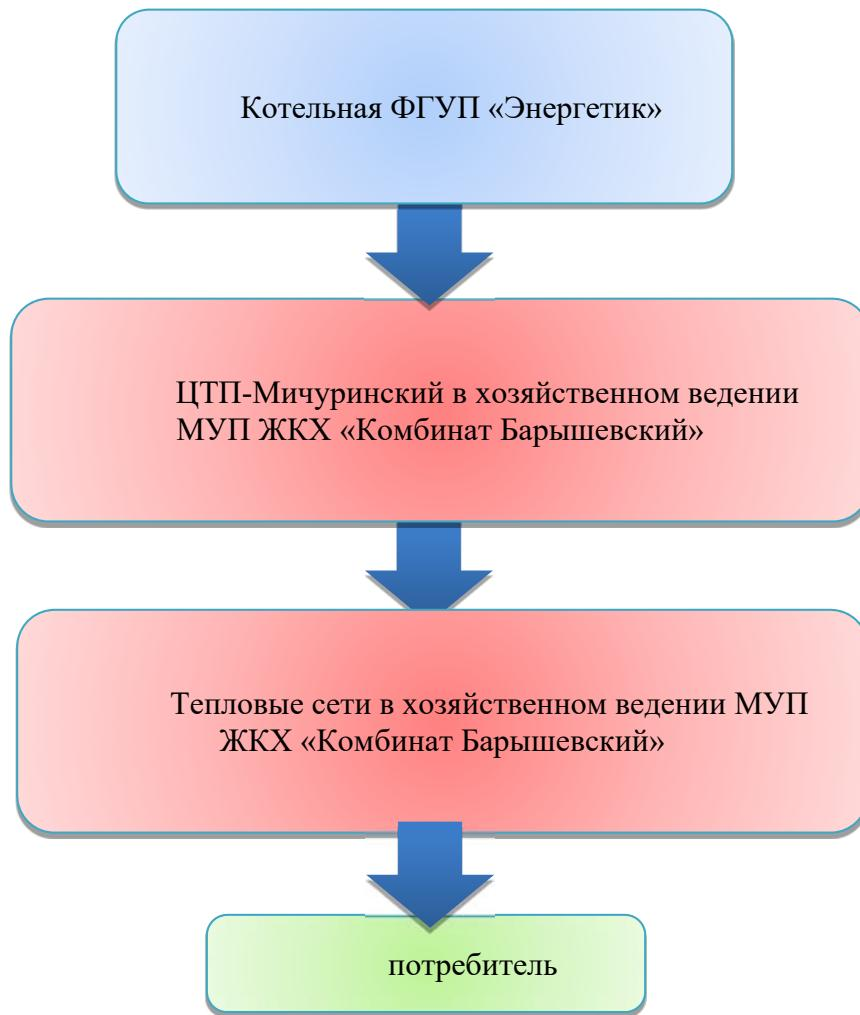
**Рисунок 1-1. Функциональная структура централизованного теплоснабжения сельсовета Мичуринский**
