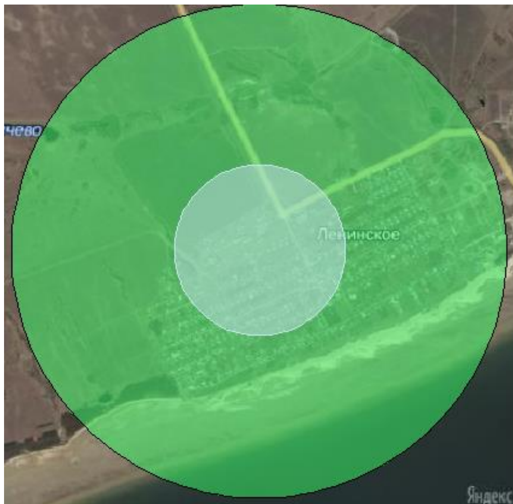
Рисунок 1.11 - Существующий и эффективный радиусы теплоснабжения газовой котельной
