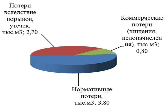
Рисунок 9 – Структурные составляющие потерь горячей воды при ее производстве и транспортировке
