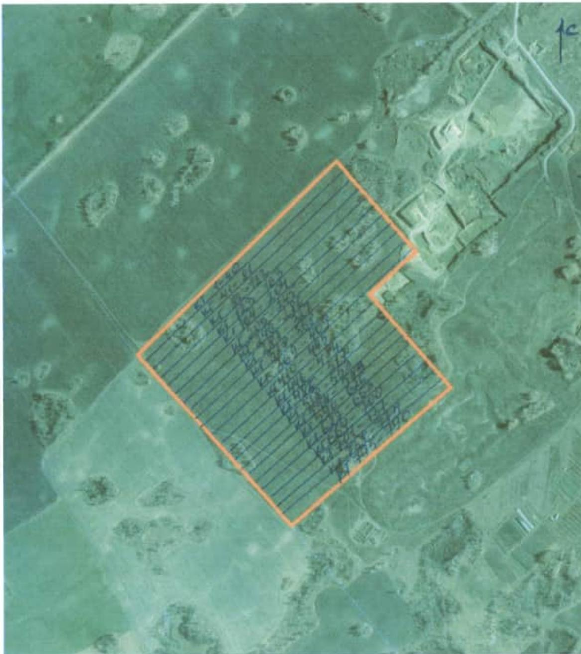
Рисунок 1 – Схематичное представление профилей поисковой гаммы-съемки и контрольных точек измерений МАЭД.
