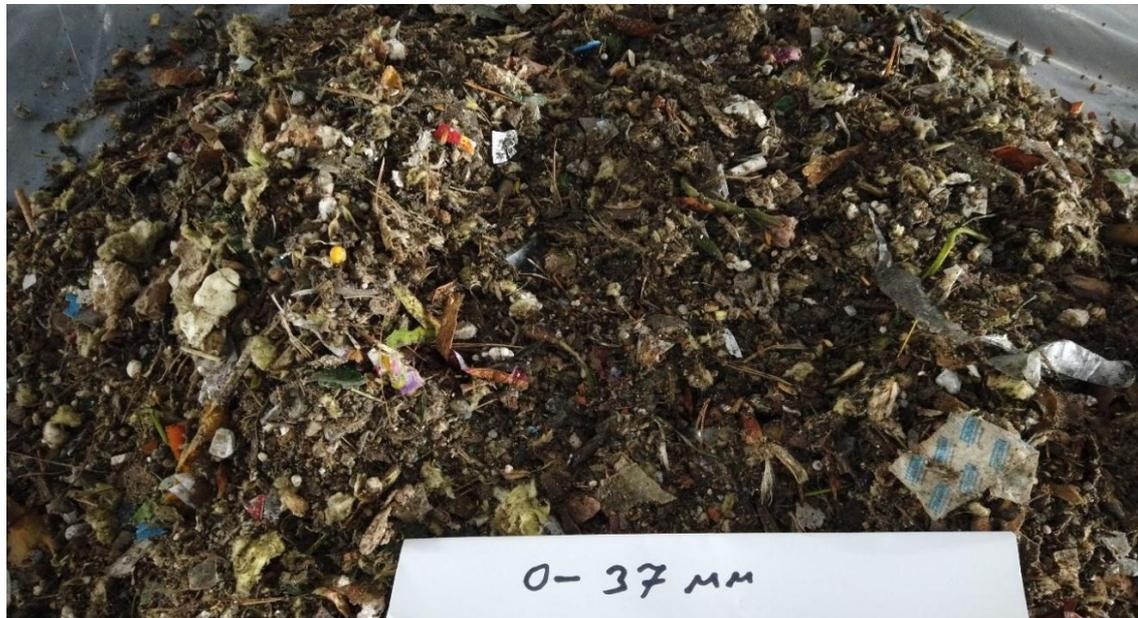
Рисунок 2 - Отсев до компостирования 0-37 мм.
