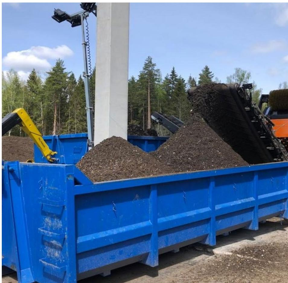
Рисунок 4 - Прокomпостированный материал, после грохочения 0-10 мм
