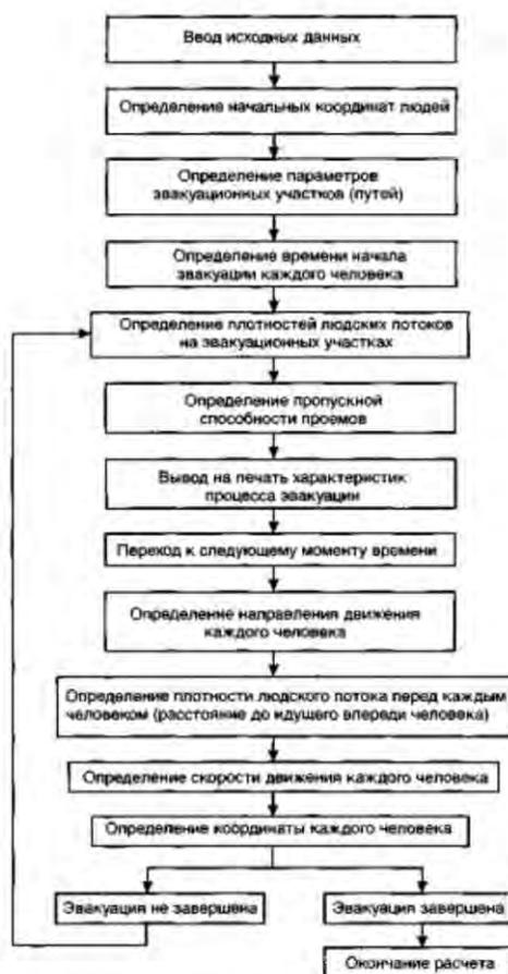
Рис. 2. Блок-схема определения расчетного времени эвакуации людей из здания.
